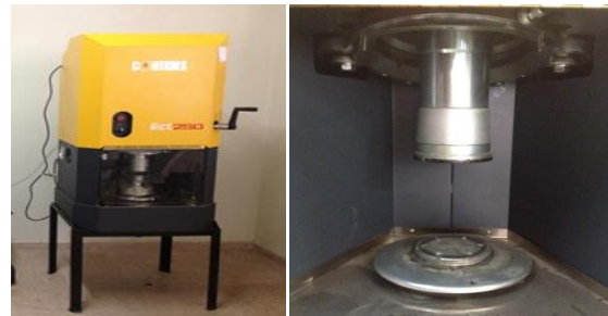
Şekil 2. Yoğurmalı pres cihazı ve sıkıştırma başlığı
