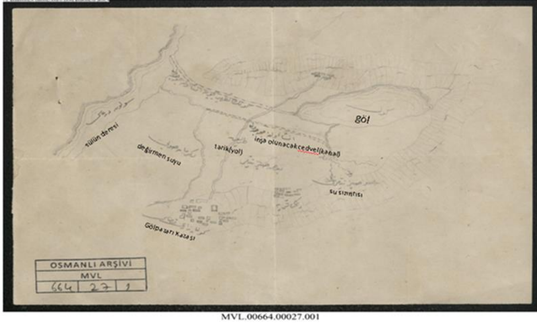
Şekil 2. Ahmed Vefik Paşa'nın Gölpazarı'ndaki göl ve bataklığı kurutmak için hazırladığı plan.
