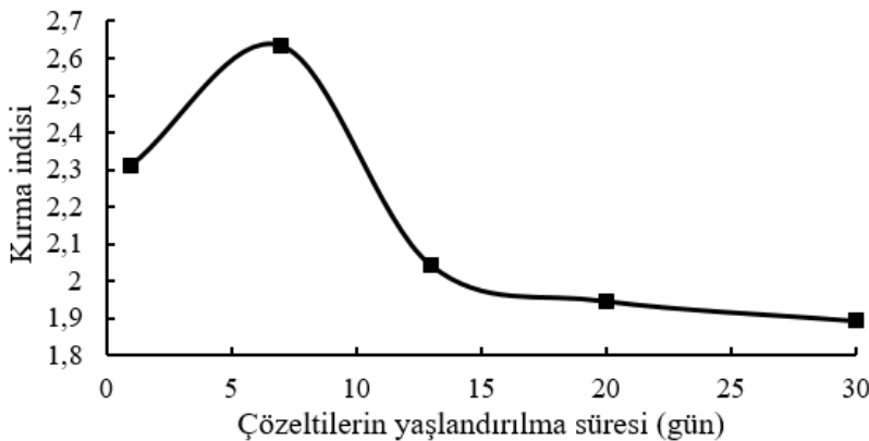
Şekil 5. Farklı süreler boyunca yaşlandırılan çözeltiler kullanılarak Si üzerine kaplanan filmlerin 530 nm dalga boyundaki kırma indislerinin yaşlandırılma süresine göre değişimi
