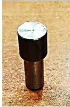
Şekil 5. Pin Formunda Aşınma Numuneleri
