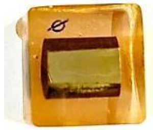
Şekil 2. Metalografik İncelenen Numunelerin Kesit Yüzeyi
