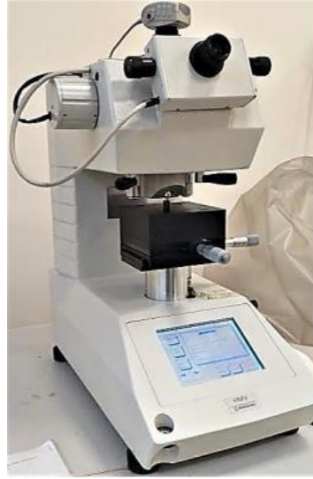
Şekil 4. Shimadzu Marka Vickers Sertlik Cihazı
