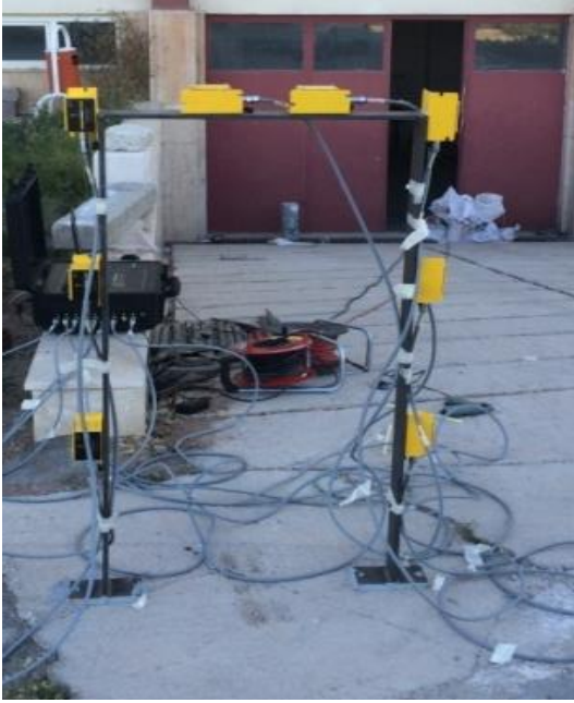
Şekil 1. Tek katlı-tek açıklıklı çerçeve sistem ve ivmeölçer yerleşimi
