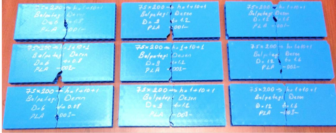
Şekil 9. PLA numunelerin eğme testi sonrası üst görünüşleri
