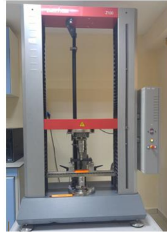
Şekil 5. Zwick/Roell marka Z100 tip çekme cihazı
