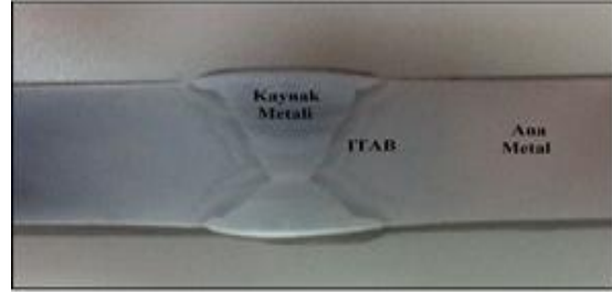
Şekil 2. X65 malzeme makroyapı fotoğrafı
