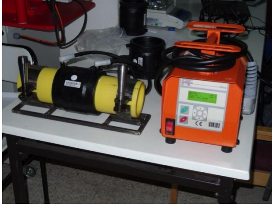
Şekil 3. Elektrofüzyon kaynak makinesi, boru konum sabitleyici
