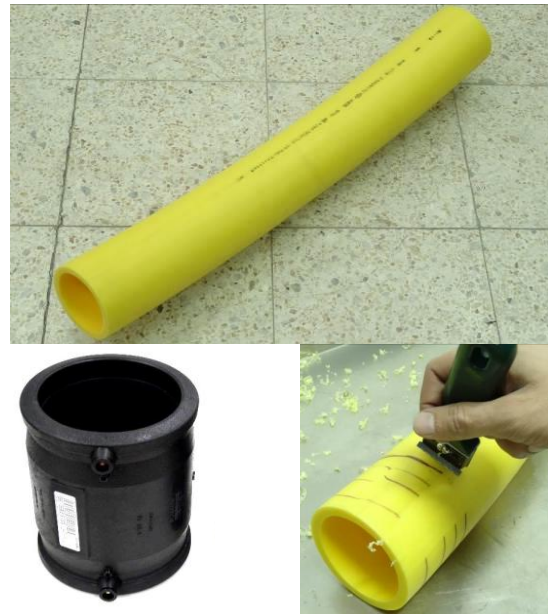
Şekil 2. PE80 boru, bağlantı elemanı ve kazıma işlemi
