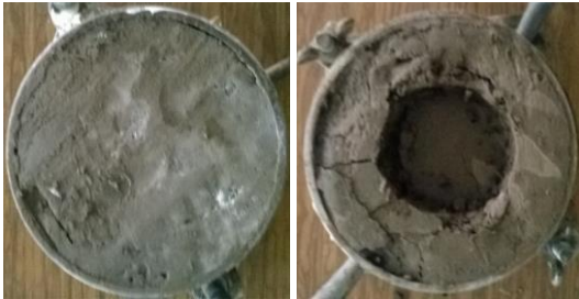
Şekil 2. CBR kalıbı ve temel/alttemel zemini
