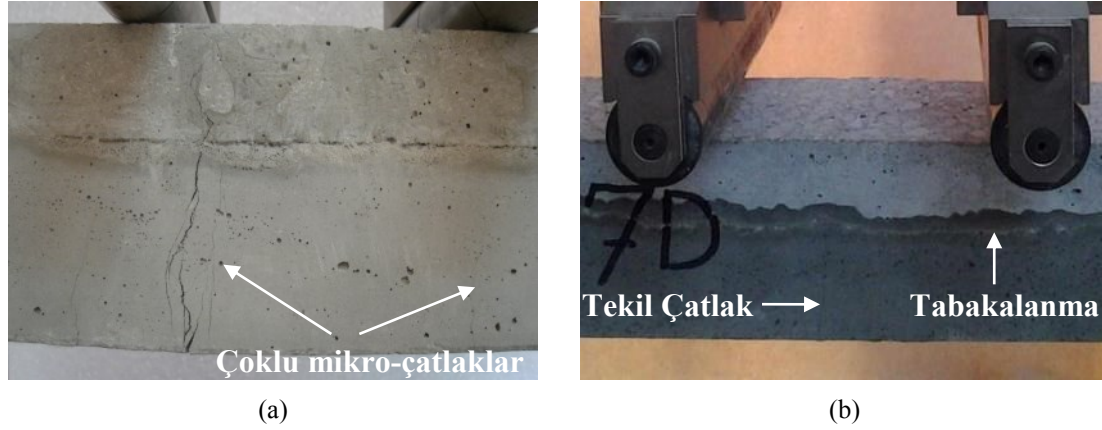
Şekil 5. Tabakalı HESECC (a) ve OM (b) karışımlarının tipik kırılma davranışları
