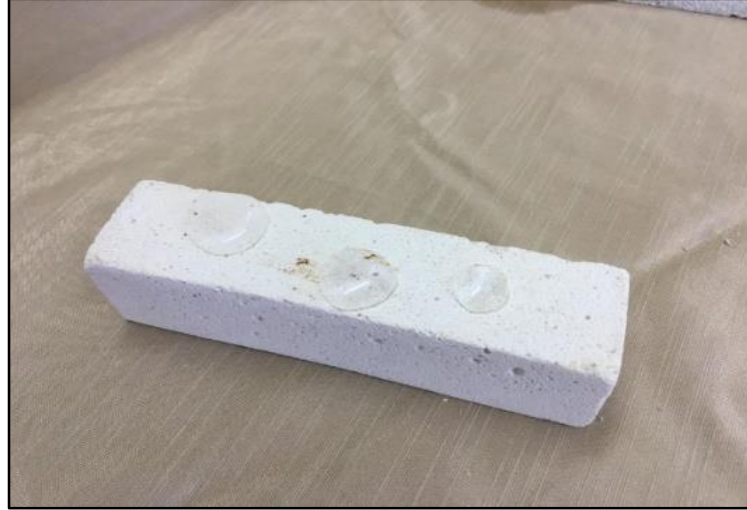
 ekil 5. Polimer bile enli sertle mi  har  rne inin hidrofob yapısına ait bir g r n m
