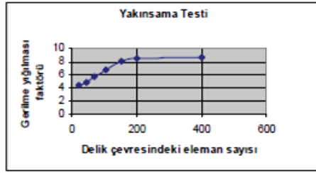
Şekil 2. Gerilme yığılması faktörünün delik çevresindeki eleman sayısına göre değişimi.
