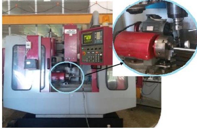
Figure 1. Tornalama-frezeleme deney düzeneği ve paralellik kontrolü Figure 1. Turning-milling test setup and parallelism control
