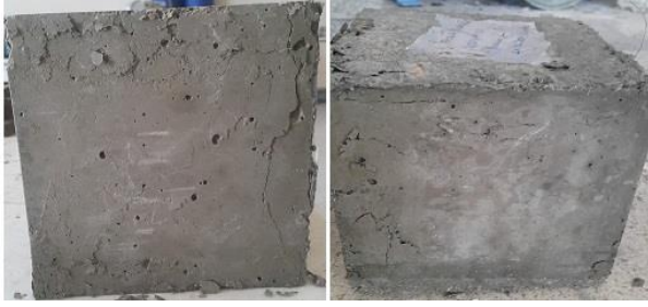
Şekil 13 .0.6MFSD1 ve 0.6MFSD2 küp numunelerinin basınç dayanımı test edildikten sonraki durumları
