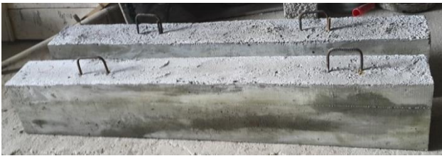
Şekil 7. 7 günlük kür işlemi ardından kalıptan çıkarılan kirişler
