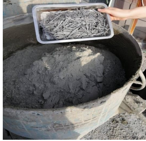
Şekil 3. Beton karışımına MFSD katılması
