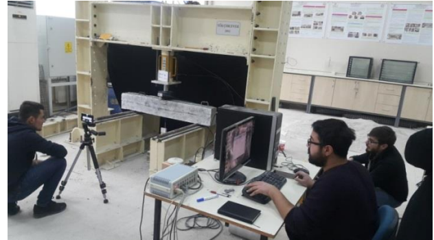
Şekil 9. 3 noktalı yükleme deneyi ve verilerin toplanması
