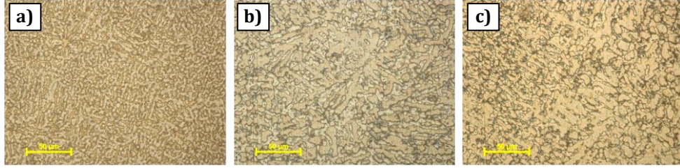
Şekil 6. Darbeli CMT kaynak işleminde ısı girdisine bağlı olarak kaynak metalinde oluşan tane boyutu değişimi; (a) D-CMT1 numaralı numune; (b) D-CMT2 numaralı numune; (c) D-CMT3 numaralı numune
