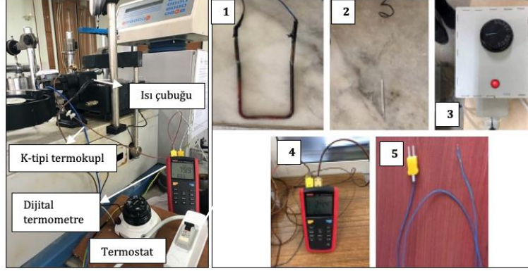
Şekil 1. Modifiye edilmiş deney düzeneği (1: ısı çubuğu, 2: termostat, 3: termostat kutusu, 4: dijital termometre, 5: K-tipi termokupl)
