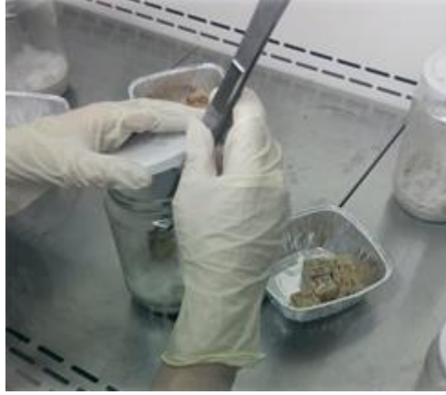
Şekil 2. Test örneklerinin mikrobiyolojik güvenlik kabiniinde kavanozlara aktarılması
