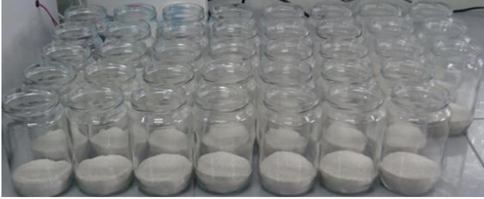
Şekil 1. Kompozit Test örneklerinin yerleştirildiği kuvars kum doldurulmuş kavanozlar.
