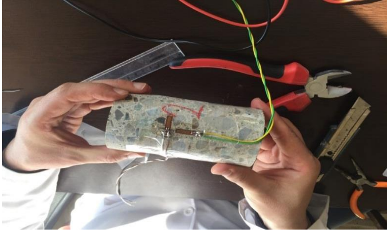
Şekil 4. Karot numunesine strain gauge bağlanması.
