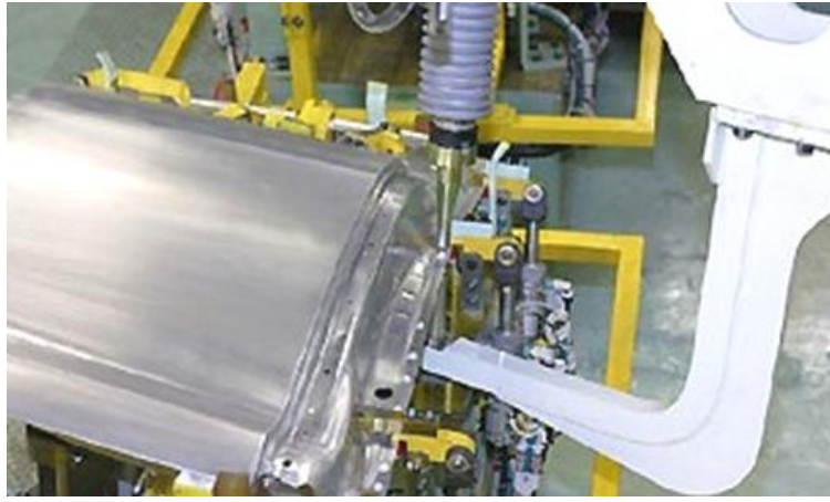
Şekil 6. Mazda RX-8'in arka kapısında SKNK uygulanırken [22, 24]
