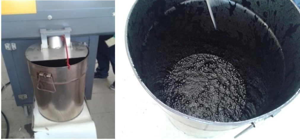
Şekil 3. Bitüm köpürtme işlemi ve köpürtme işlemi sonrası sönmüş bitüm
