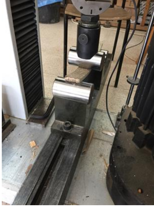
Şekil 2. Eğilme direnci ve eğilmede elastikiyet modülü tayini
