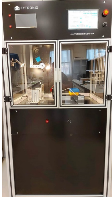
Şekil 1. Elektro eğirme sistemi (FYTRONIX ELECKROSPUN SYSTEM ESP9712).
