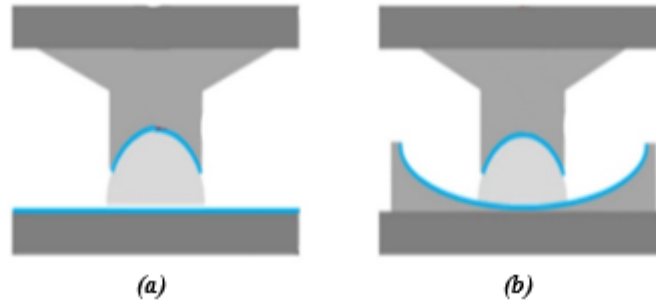
Şekil 1. (a) Düz yüzeyli ve (b) eğri yüzeyli sürtünmeli sarkaç izolator
