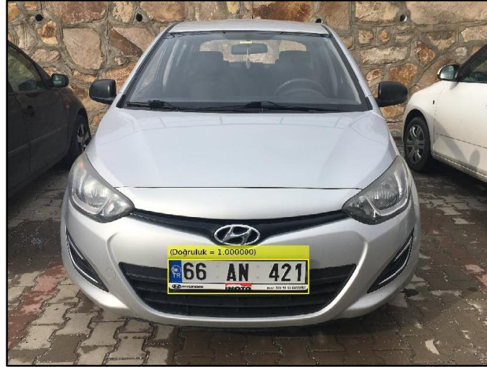
Şekil 8. R-CNN ile bulunan plaka konumu.
