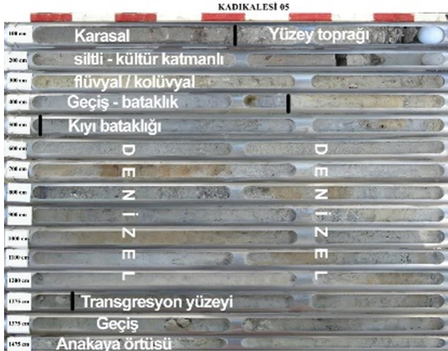
Şekil 7- 05 numaralı sondaja ait sondaj karotu ve karota ait alüvyon stratigrafisi ve ortam değerlendirmesi.
