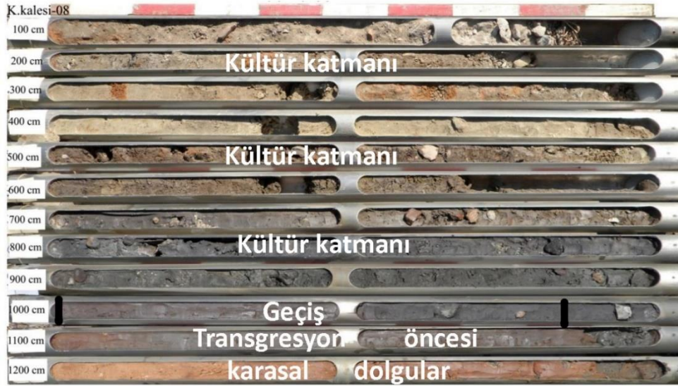
Şekil 5- 08 numaralı sondaja ait sondaj karotu ve karota ait alüvyon stratigrafisi ve ortam değerlendirmesi.
