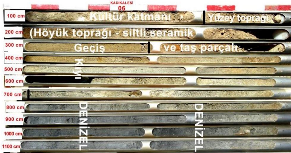
Şekil 8- 06 numaralı sondaja ait sondaj karotu ve karota ait alüvyon stratigrafisi ve ortam değerlendirmesi.
