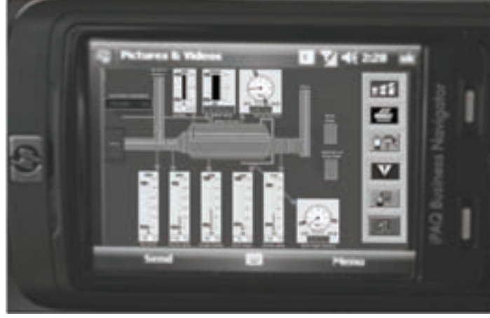
Şekil 6. PDA üzerindeki SCADA görüntüsü
