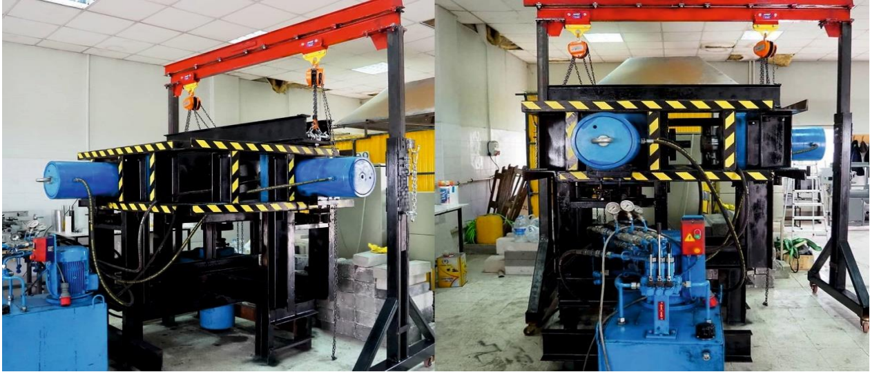
Şekil 14. İmal edilmiş hücre ve ona bağlı vinç.
