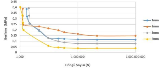
Şekil 7. Yüzeyinde herhangi bir kimyasal kaplama veya boya işlemi uygulanmayan numunelerin S-N eğrisi
