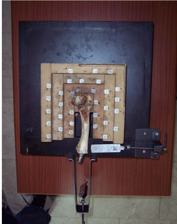
Şekil 2. Güç sensörü eklenmiş kalibrasyon kutusu.
