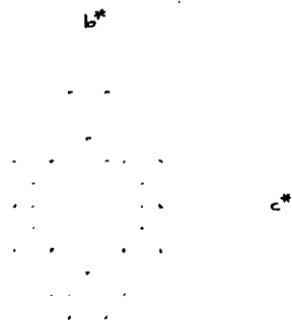
Şekil 5. (h1l) Buerger Presesyon Üst Tabaka Fotoğrafı, 45 kV, 26 mA, CuK \alpha , filtresiz, ışınlama sü- resi:19 saat.
