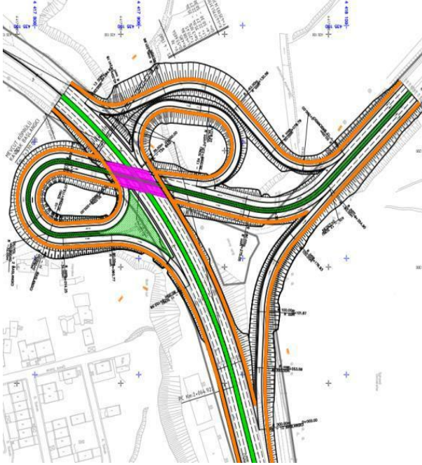
Şekil 2. Yapımı düşünülen kavşağın CAD çizimi.
