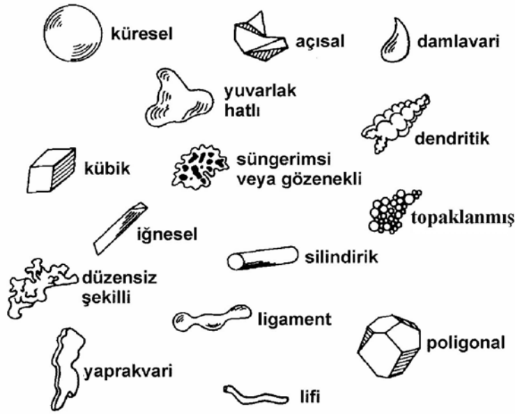
Şekil 2. Çeşitli üretim teknikleri ile üretilmiş toz şekilleri [3].
