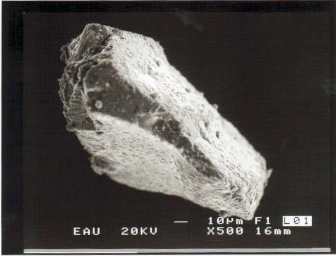
Şekil 3. Ultrases enerjisi kullanılarak yapılan denemeye ait SEM görüntüsü ( Sıcaklık : 50°C, Amplitüt hızı : 50 %)
