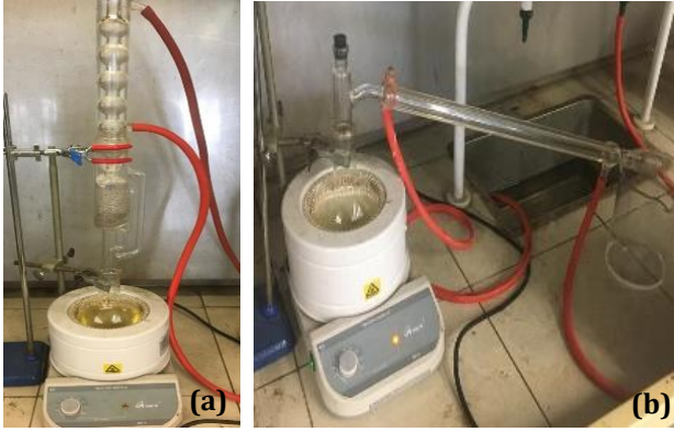
Şekil 2. a) Soxhlet Ekstraksiyonu Yöntemiyle Bitkisel Yağ Elde Edilen Deneysel Düzenek b) Damıtma Sistemi Düzeneği
