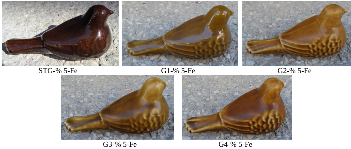
Şekil 4. Kalsit katkılı standart sırda demir oksitin renk ve yüzey etkileri (1160 °C)
