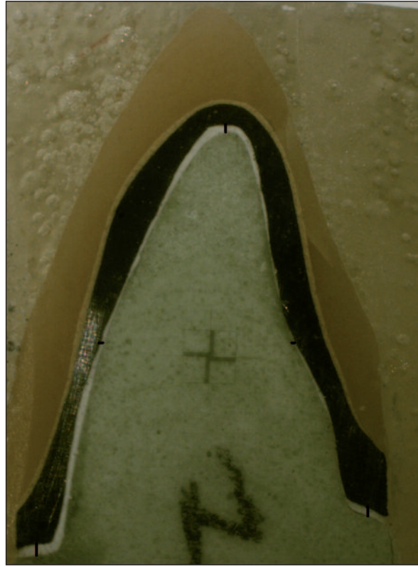
Şekil 1. Kesit yüzeyi üzerinde ölçüm yapılan 5 nokta (x13)
