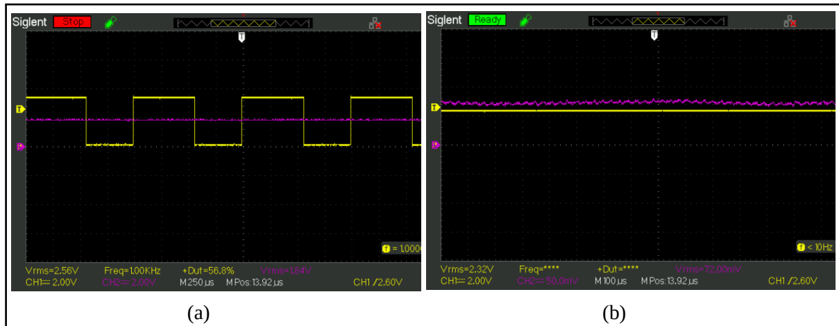
Şekil 9. (a) Azaltan dönüştürücü girişine uygulanan PWM sinyali (CH1), dönüştürücü çıkışından elde edilen V_{GS} gerilimi (CH2), (b) MOSFET'in tetikleme terminaline uygulanan V_{GS} gerilimi (CH1), MOSFET üzerinden geçen dengeleme akımı (CH2).
