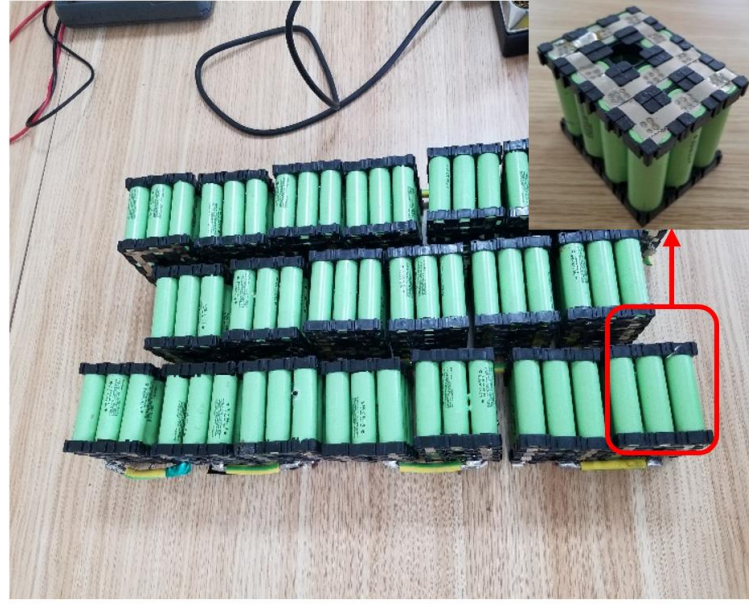
Şekil 1. Batarya hücrelerinin hiyerarşik yapısı
