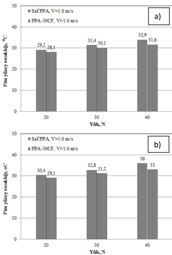
**Şekil 6.** Saf PPA polimeri ve PPA-30CF kompozitin uygulanan yükle bağlı olarak a) pim yüzey sıcaklıklarını b) çelik disk yüzey sıcaklığı değişimini (Variation of depending on the applied load of pure PPA polymer and PPA-30CF composite; a) pin surface temperatures b) steel disc surface temperature variation)
