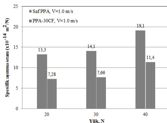
**Şekil A:** Saf PPA polimeri ve PPA-30CF kompozitin uygulanan yükle bağlı olarak spesifik aşınma oranının değişimi / **Figure A:** The variation of the specific wear rate of pure PPA polymer and PPA-30CF composite with applied load
