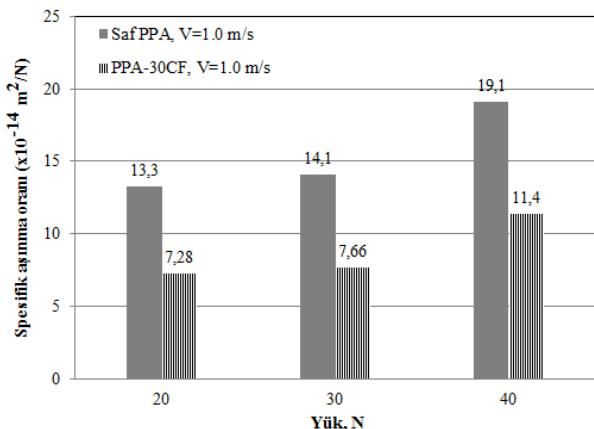
**Şekil 7.** Saf PPA polimeri ve PPA-30CF kompozitin uygulanan yükle bağlı olarak spesifik aşınma oranının değişimi (The variation of the specific wear rate of pure PPA polymer and PPA-30CF composite with applied load)
