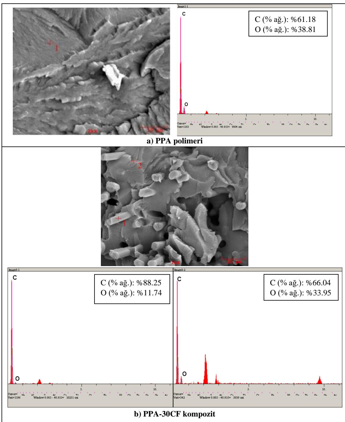
**Şekil 4.** EDS analizi ve belirtilen noktalarda yapılan EDS analiz sonuçları (% ağı.) (EDS analysis and results of EDS analysis at specified points (% wt.))
