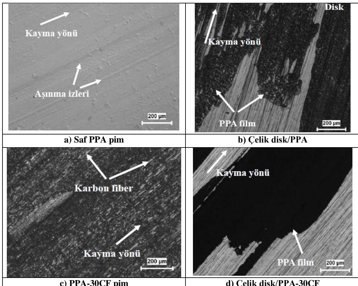
**Şekil 8.** Saf PPA polimeri ve PPA-30CF kompozitin pim ve disk aşınma yüzeylerine ait optik mikroskop mikroyapı görüntüleri (Yük: 40N, Hız 1.0m/s) (Optical microscope microstructure images of pin and disc wear surfaces of pure PPA polymer and PPA-30CF composite (Load: 40N, Speed 1.0m/s))
