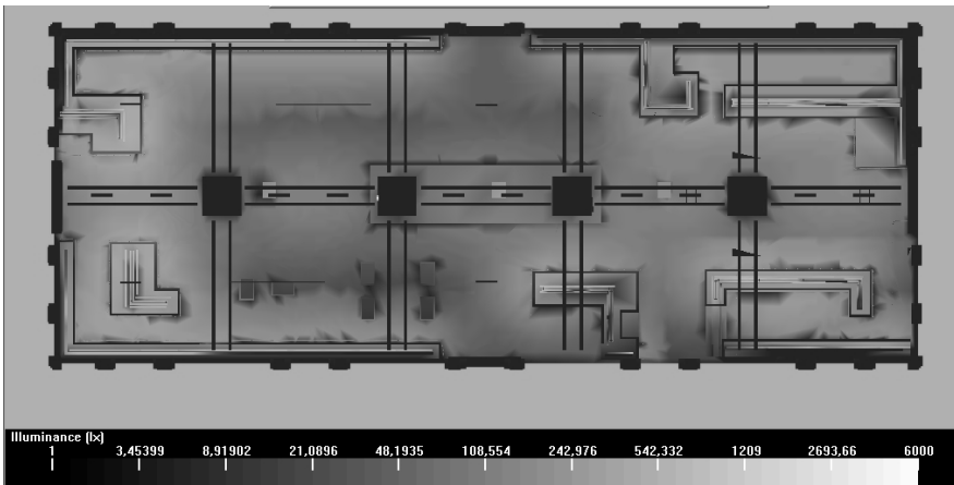
Şekil 3. Mevcut durumda çalışma düzlemindeki aydınlık seviyeleri
