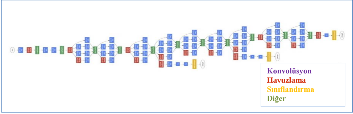
Şekil 17. GoogLeNet ağ mimarisi (Szegedy, Liu et al. 2015)
