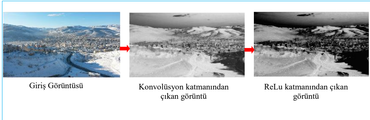
Şekil 8. Bir ESA modelinde konvolüsyon katmanı ve ReLu katmanının giriş görüntüsüne yapmış olduğu etki
