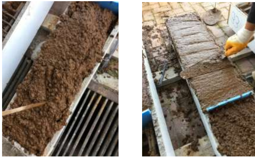
Şekil 3. Beton yerleştirme ve masterlanma anı Figure 3. Place of concrete and leveling time
