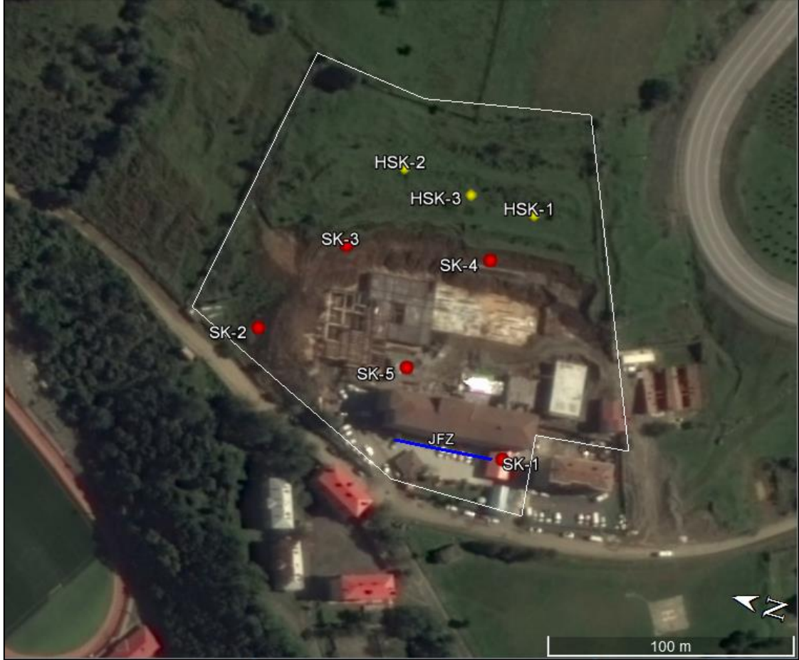
Şekil 4. Çalışma alanı içindeki sondajların ve sismik kırılma hattının uydu fotoğrafındaki görünümü
