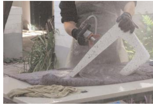
Resim 10:David Binns çalışmaları taşlama aşaması
