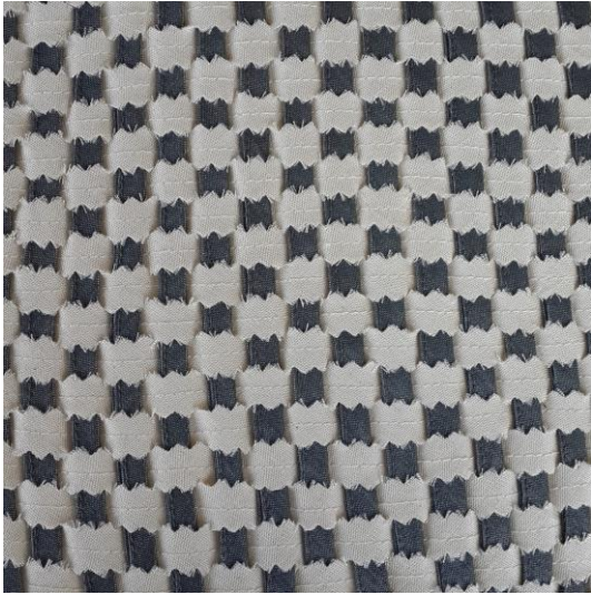
Şekil 4. Deneysel Uygulama, 2014, Orijinal. Tasarım boyutu: 20 cm x 20 cm Kumaş boyutu: 100 cm x 100 cm Dokuma tekniği: Bezayağı Çözüğü: 0.75 cm (bitmiş biye) Atkı: 1.5 cm (bitmiş şerit)
