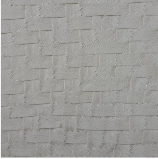
Şekil 3. Deneysel Uygulama, 2014, Orijinal. Tasarım boyutu: 20 cm x 20 cm Kumaş boyutu: 100 cm x 100 cm Dokuma tekniği: Z/S yönlü dimi Çözüğü: 0.75 cm (bitmiş biye) Atkı: 1.5 cm (bitmiş şerit)
