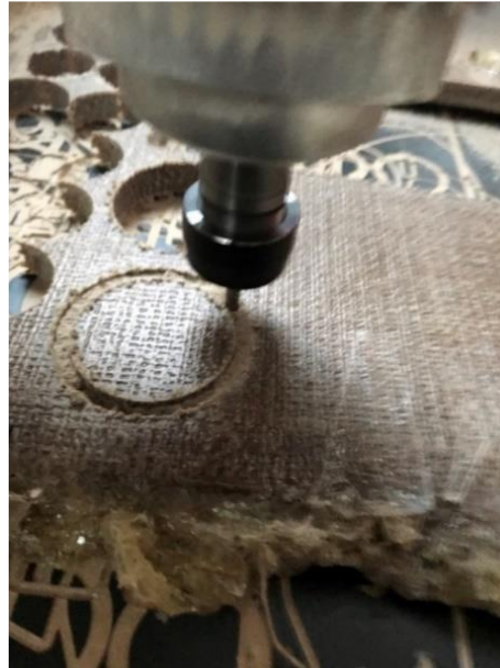
Şekil 4. Test Örneklerinin CNC ile Kesilmesi
