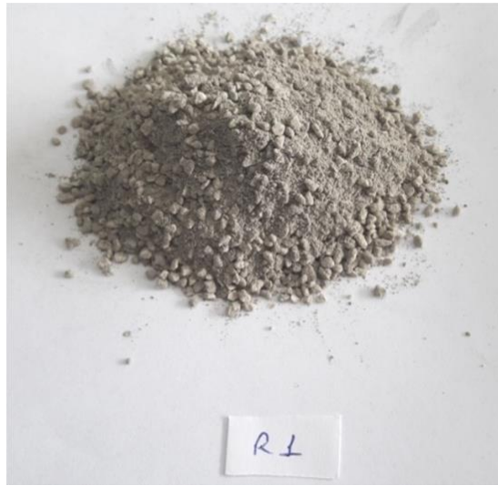
Şekil 3. R1 Karışımı Tamir Harcı Toz Formu
