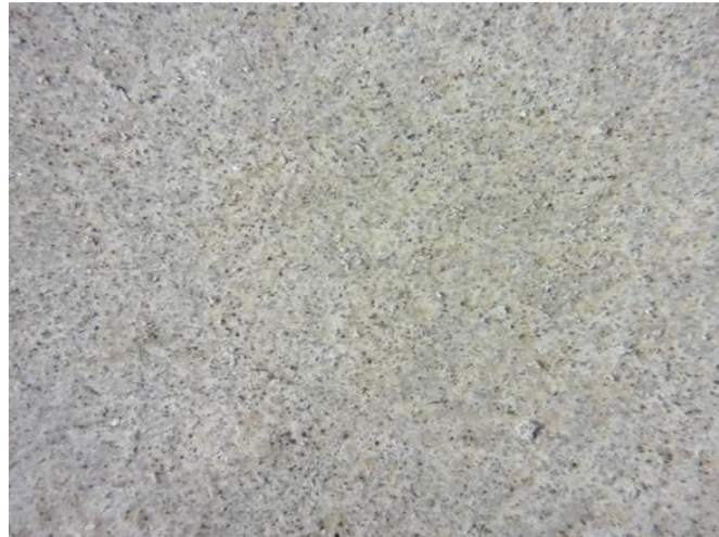
Şekil 8. Kontrol Harcı R0 Matris Yapısı
