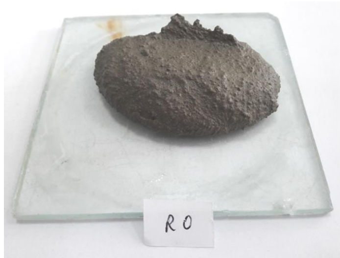
Şekil 2. R0 Karışımı Tamir Harcı Taze Yaş Harç Formu
