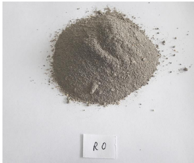
Şekil 1. R0 Karışımı Tamir Harcı Toz Formu
