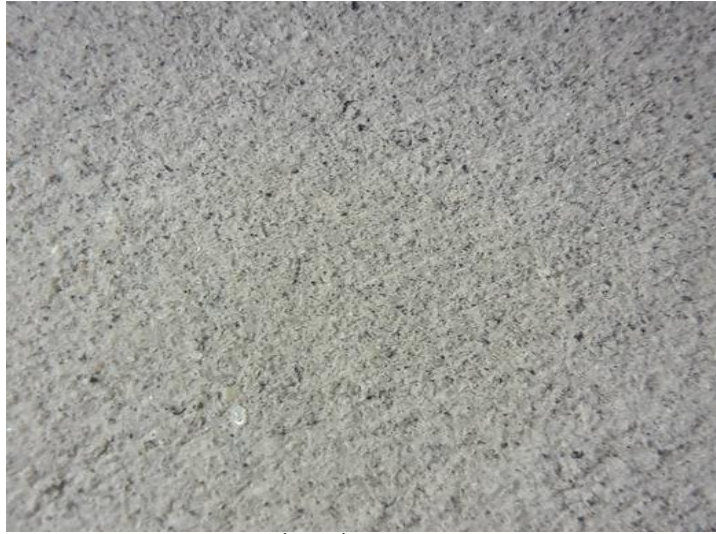
Şekil 10. %80:%20 İnce:İri Pomzalı R7 Matris Yapısı
