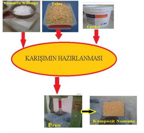
Şekil 3. Kompozit Malzemesini Üretim Şeması
