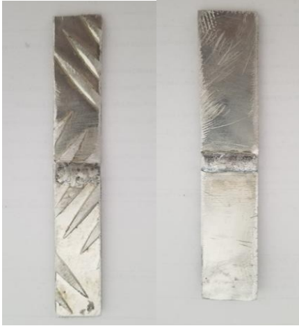
Şekil 2. Çekme testi için hazırlanan numuneler.
