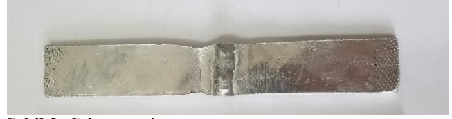
Şekil 3. Çekme testi sonrası numune.
