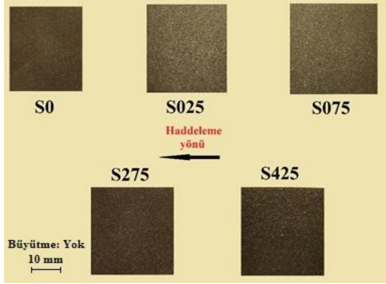
Şekil 3. Farklı ezme miktarları ile temper haddelenen HC420LA sac malzeme numunelerinin yüzey görüntüleri
