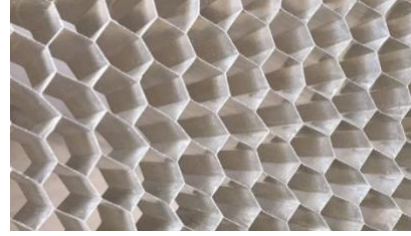
Şekil 10. Kanat petek yapısının üstten görünüşü Şekil 11. Altıgen petek kanat modeli panel görünüşü
